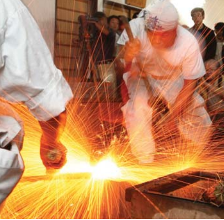
公開古式鍛錬 備前おさふね刀剣の里では大槌を振り下ろし、火花を散らしながらたたいては折り返す古式鍛錬の様子を月1回公開しています。
