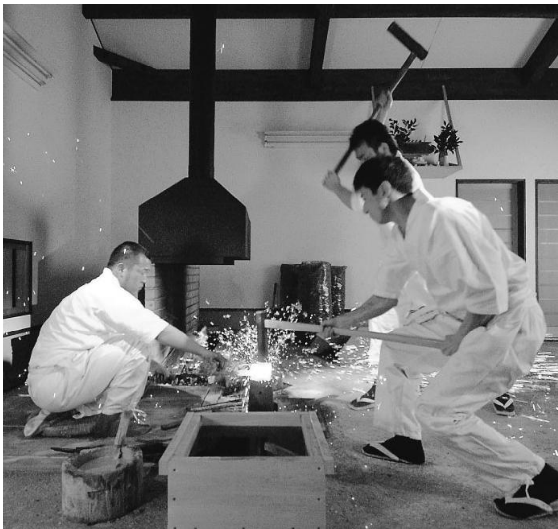
備前長船鍛冶場では、鍛錬作業を公開。1,300度の高温と職人が打ちのばす圧力で玉鋼から不純物を取り除いています（長船町長船）
