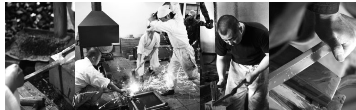
名刀は多くの工程を経て完成(写真左から)心・皮鍛接／鍛錬／素延べ／研ぎ
