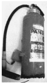
破裂した消火器は、底の溶接部分が著しく腐食
