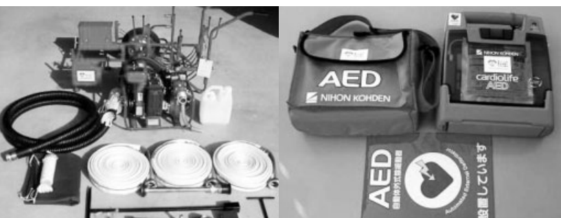
支給された軽可搬ポンプとAED
