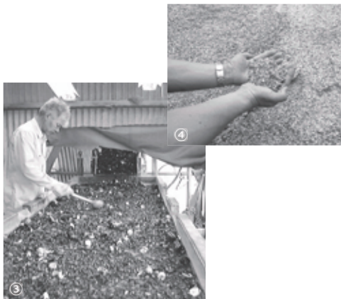
③粉碎されたビンラベルやキャップなどを人の目で選別／④出来上がった粒状のカレット
