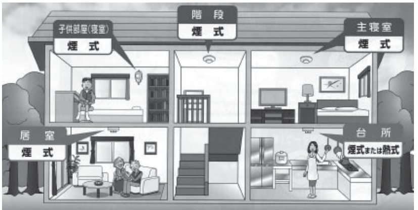
火災警報器の設置場所と種類
