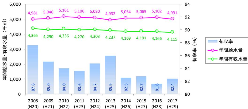
図-5 年間給水量、有収水量及び有収率の推移
