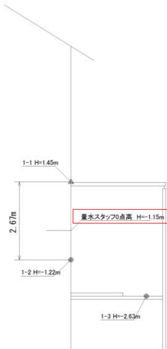
図-1.2.4-5 ポンプ施設量水スタッフと標高測定模式図（縮尺なし）
