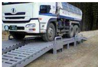
図-6.2.4-9 タイヤ洗浄機(乾式)事例
