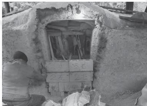
天井まで隙間なく原木が詰められた炭焼き窯
