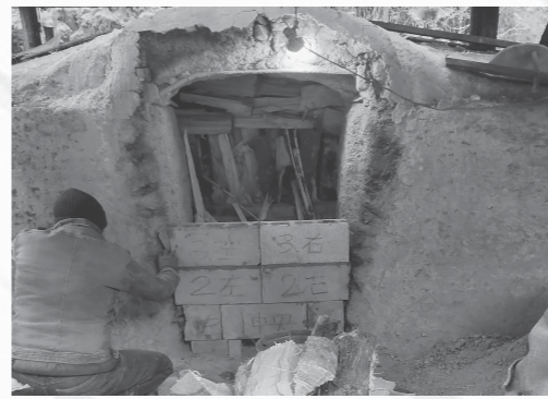
天井まで隙間なく原木が詰められた炭焼き窯
