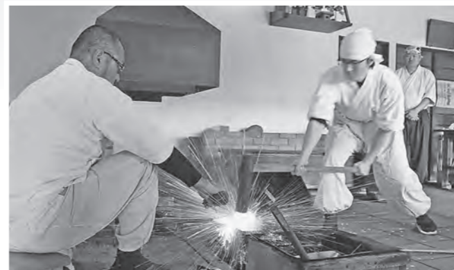
重い鎚を振り降ろし、玉鋼を打つ鍛錬の様子
