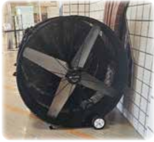
直径125cmの大型送風扇（兵庫県内体育施設）
